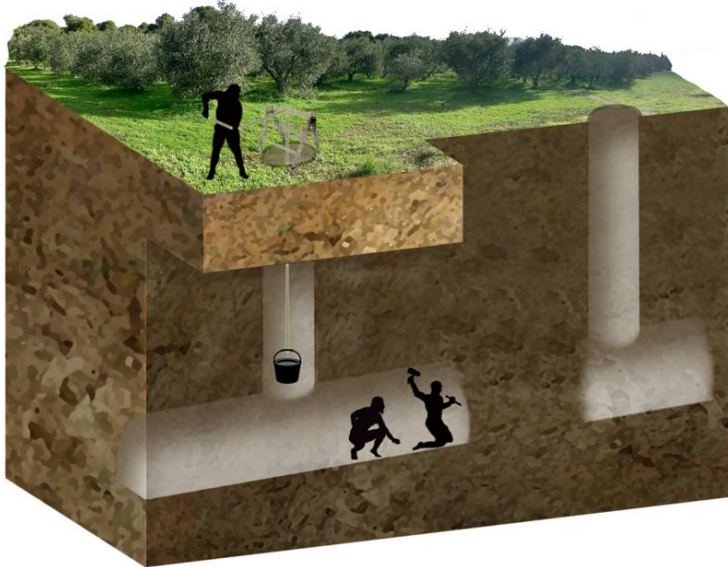
Κατασκευή της σήραγγας του Αδριάνειου υδραγωγείου
